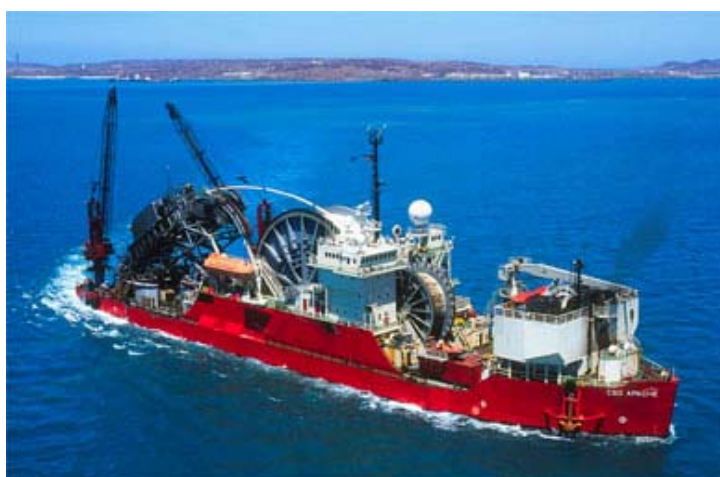
Figura 11 – Navio de lançamento de linhas. Fonte: Origin Energy.
