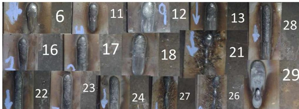
Figura 4.3 – Soldas que apresentaram modo de transferência por Curto-Circuito.
