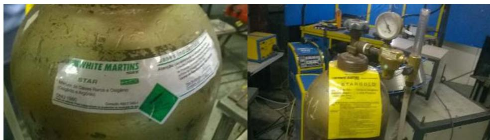
Figura 3.0 – Gás de proteção utilizado – Mistura de 98% Ar e 2% O<sub>2</sub>.
