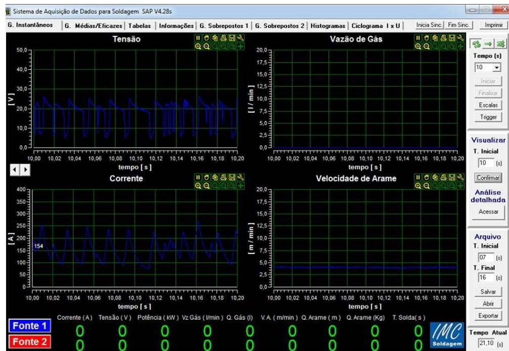
Figura 3.4 – Ilustração do programa SAP 4.0 mostrando os gráficos de tensão, corrente e velocidade de alimentação, referentes a solda de número 6, com tensão de 18V e velocidade de alimentação de 4 m/min.
