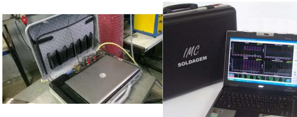
Figura 3.3 - Maleta de aquisição de dados - IMC Soldagem.
