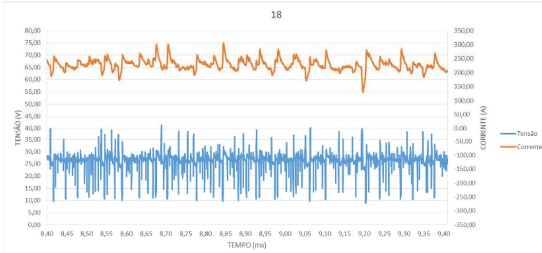
Figura A.18 – Gráfico de Tensão, Corrente e tempo no Teste 18 – Tensão 24V e Velocidade de Alimentação de 8 m/min.
