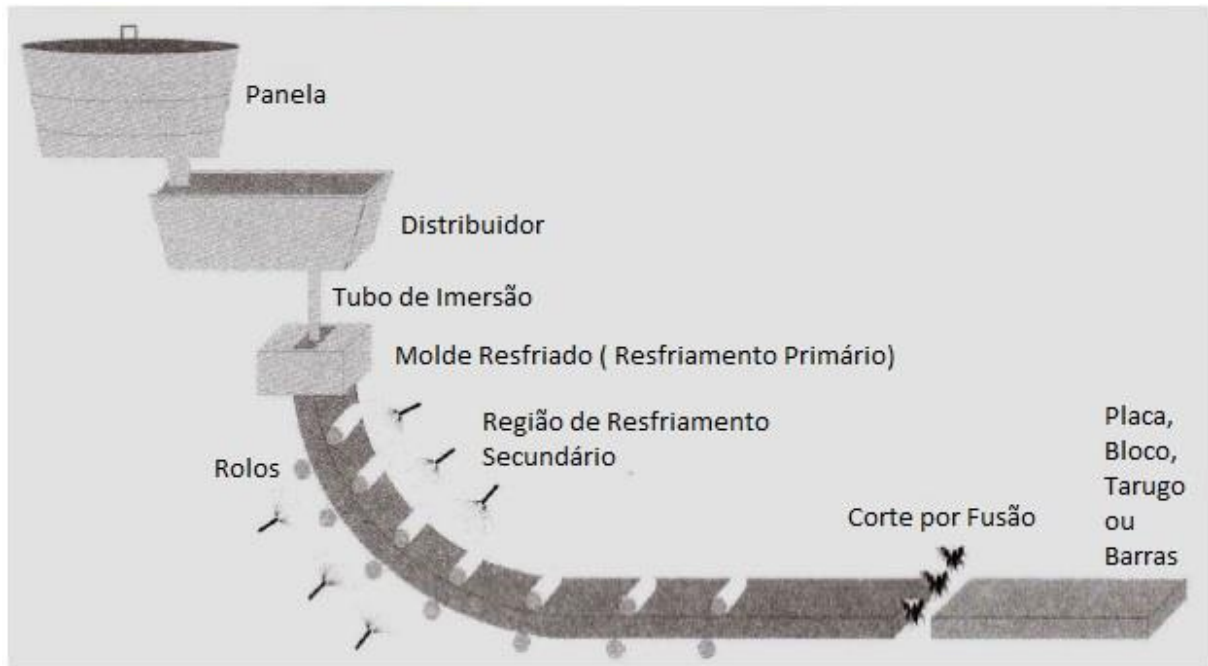
Figura 3 – Representação esquemática de uma máquina de lingotamento contínuo moderna.
